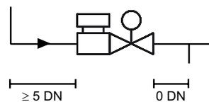
**Opomba:** Potreben je prostor nad pogonom/potopno pušo za temperaturni senzor za enostavno montažo / demontažo.
